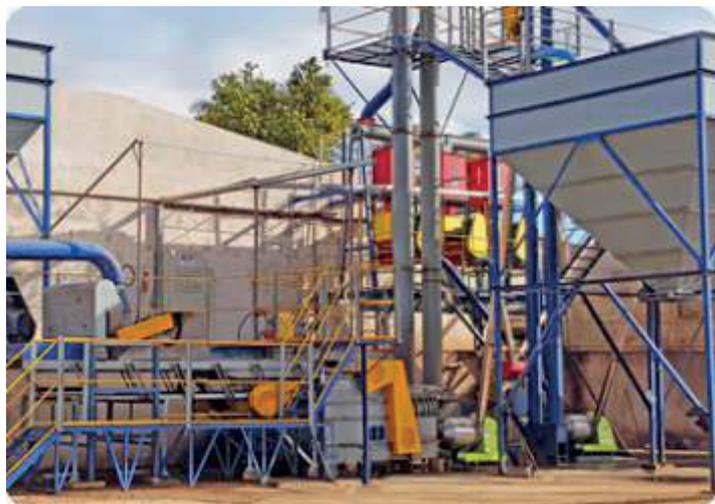
É uma máquina 2 em 1, que centrifuga e transporta em fluxo contínuo **TODOS OS TIPOS DE CAFÉ** que são processados na via úmida, deixando-os enxutos para as etapas seguintes de secagem.
